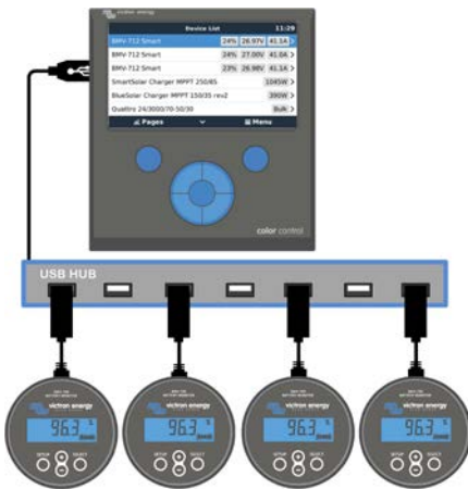
Maximalt fyra BMV enheter kan anslutas direkt till Color Control. Ännu fler BMV enheter kan anslutas till en USB-sticka för central övervakning.
