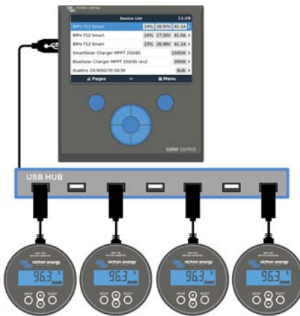
Maximalt fyra BMV enheter kan anslutas direkt till Color Control. Ännu fler BMV enheter kan anslutas till en USB-sticka för central övervakning.
